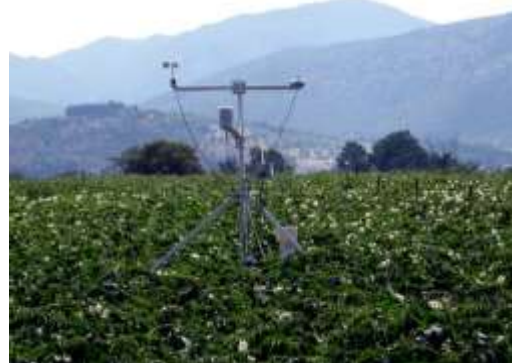
Εικόνα 2. Αυτόματος μετεωρολογικός σταθμός Γ.Π.Α. (AUA) εγκατεστημένος σε υπόβαθρο με χαμηλή πράσινη βλάστηση και με πλήρη επάρκεια εδαφικής υγρασίας, σε όλη την διάρκεια της καλλιεργητικής περιόδου.
